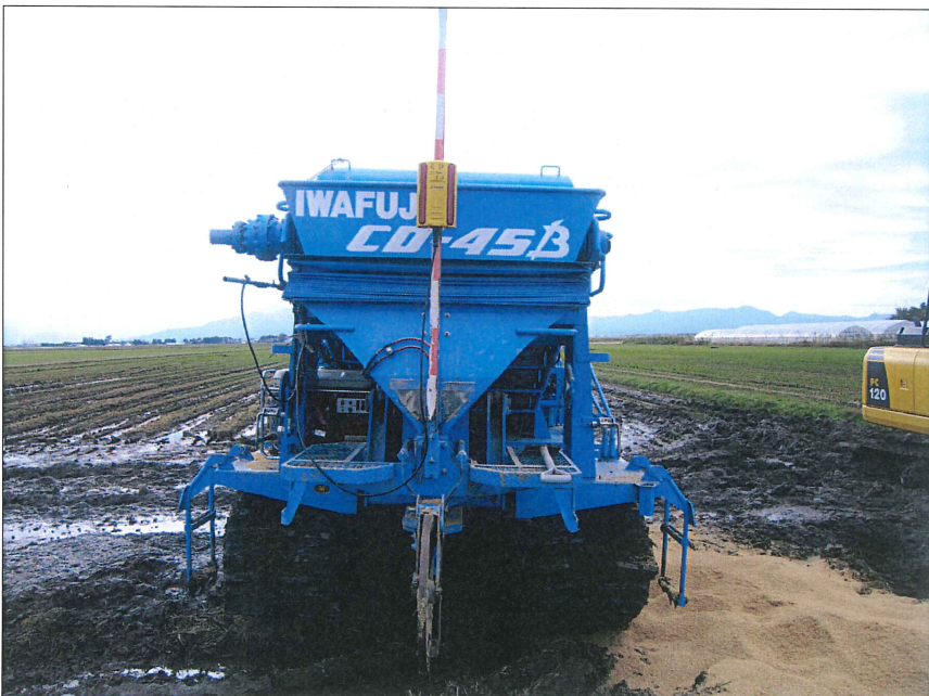
試験施工 リバース工法 レーザーレベル 受光器
